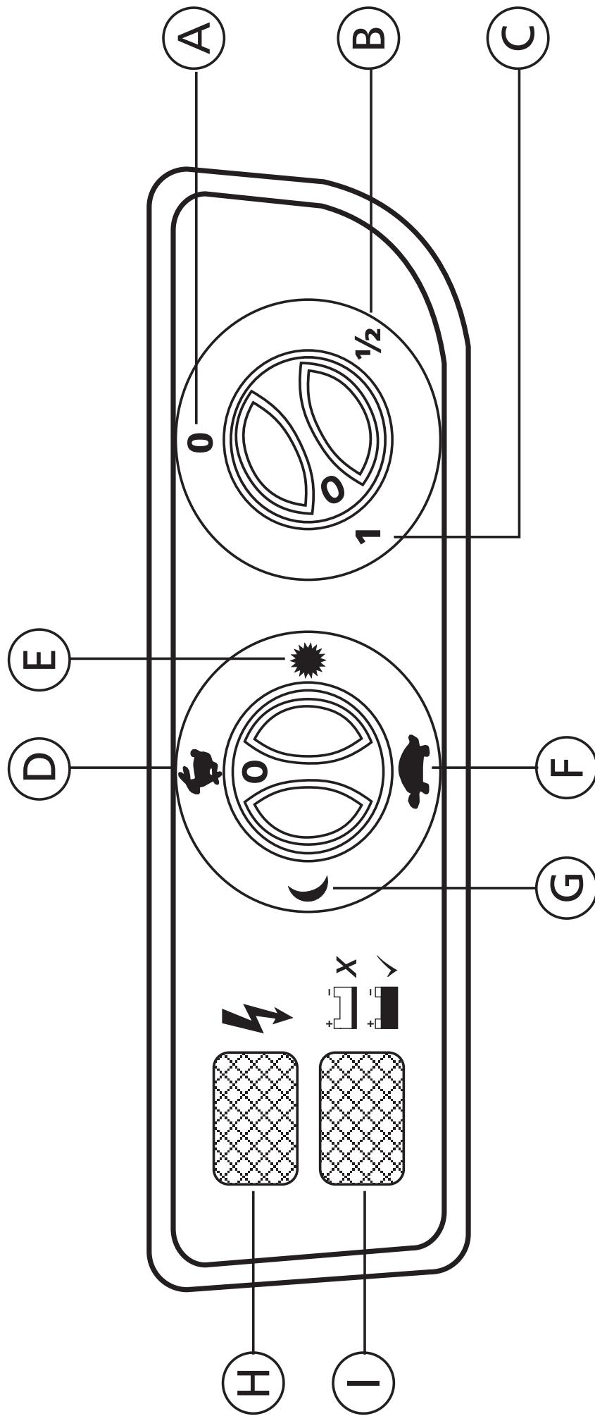
Schakel het schrikdraadapparaat naar half vermogen (B) voor een optimaal energieverbruik. Als het rode lampje (H) niet brandt, schakel dan het schrikdraadapparaat naar maximaal vermogen (C) om voldoende voltage op de afrasteringsdraad te houden.
