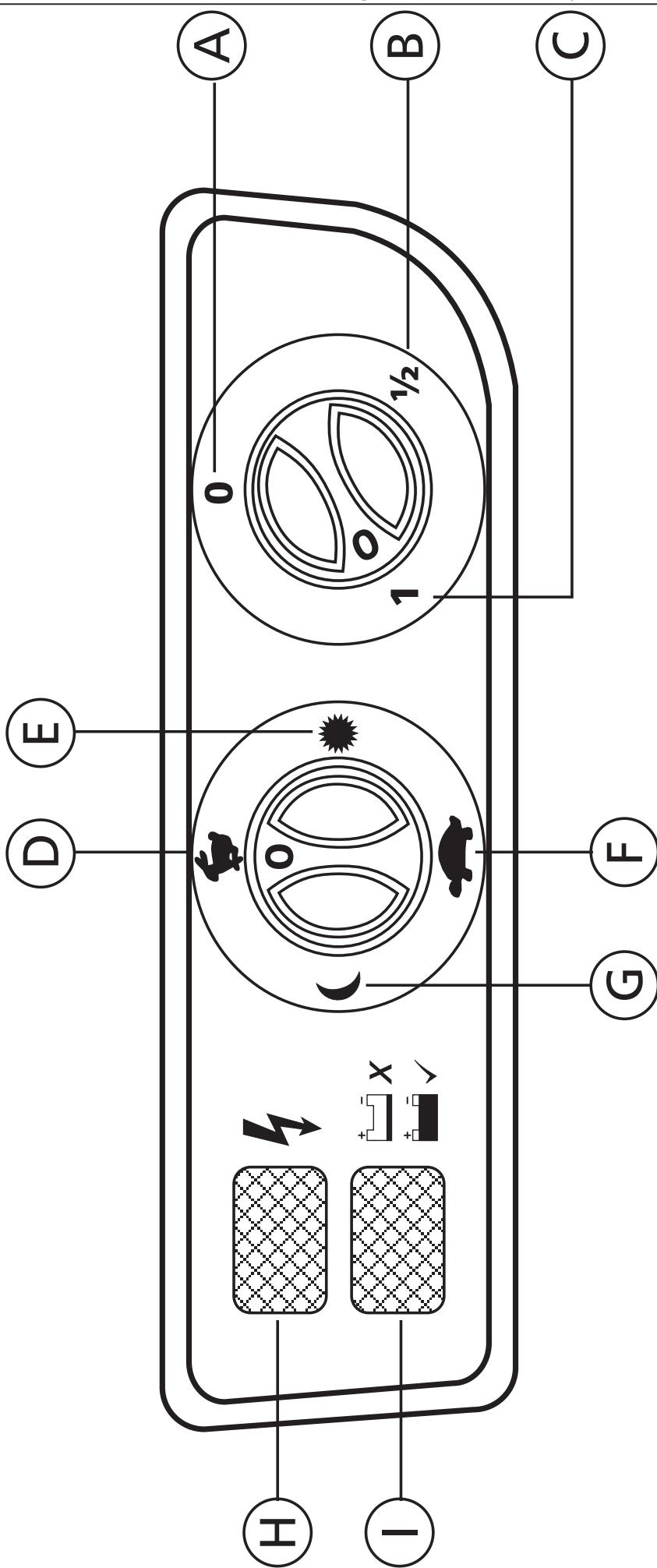
Para un funcionamiento óptimo de la batería, encienda el energizador a potencia media **B**. Si el indicador rojo **C** para así mantener el suficiente voltaje en la cerca **H** no parpadea,
