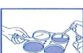
3. Par inclinaison du plateau, l'excédent de lait sera déversé jusqu'à la graduation.
