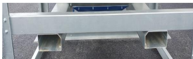
Fourreaux de déplacement
