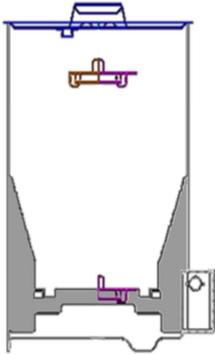
Une cuve en acier inoxydable, d'un volume de 30 litres, rassemble un élément chauffant, une sonde à maximum ainsi qu'une sonde de régulation. Deux poignées en font un ensemble facilement transportable.
