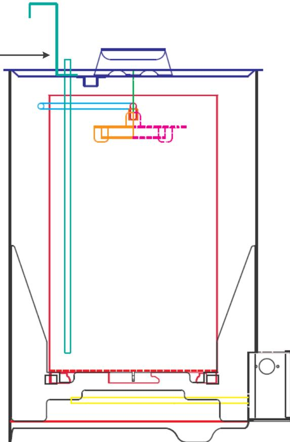
5. Connecter le boîtier électronique à la cuve par l'intermédiaire des deux fiches à verrouillage.
