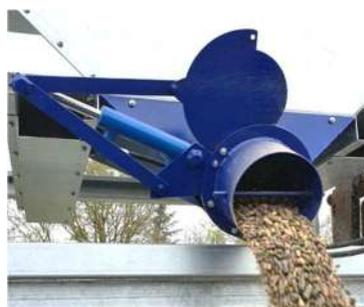
Trappe hydraulique par vérin Double Effet
