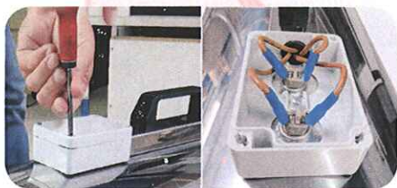
Coffret à thermostats sur le dessus, facilement accessible.
