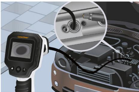
– **Localisation du problème :** la caméra montre ce qui se trouve derrière ou dans des objets, cloisons, conduites, câbles, etc., également dans de mauvaises conditions d'éclairage et ce, grâce à l'éclairage LED.
