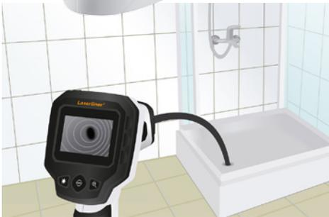
– **La tête de la caméra, montée sur flexible,** retransmet directement les images sur le moniteur LC.
