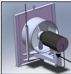
Le malaxeur doit être VISSE sur la cage de concentration avec des RONDELLES ANTI VIBRATOIRES (Gower ou Nord-lock)
