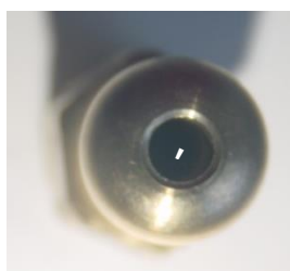
Le gicleur partiellement bouché
