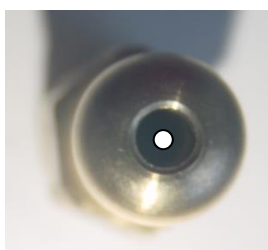
Le gicleur débouché
