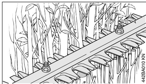
Le modèle HS 82 R convient pour les gros travaux de rabattage, c'est-à-dire de réduction de hauteur et de largeur de haies et de buissons à branches assez épaisses.
