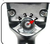
Sens d'appui sur l'inverseur pour le Déserrage. (Vis pas à droite)
