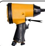
Sens d'appui sur l'inverseur pour le Déserrage. (Vis pas à droite)
